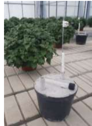
Figure 2 : Illustration du dispositif expérimentale de prélèvement des COVs en phase 2 et d'une fibre SPME lors d'un prélèvement
