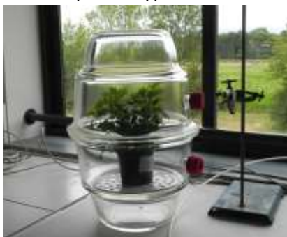
Figure 3 : Illustration du dispositif expérimentale en cloche de prélèvement des COVs et des échantillons de plantes pour le passage en HeadSpace
