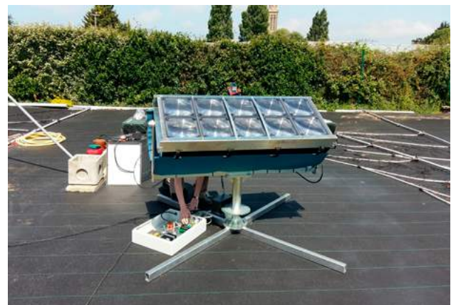
FIGURE 5 : CAPTEUR SOLAIRE AVEC 10 LENTILLES DE FRESNEL DÉVELOPPÉ PAR LA SOCIÉTÉ ECHY. CRÉDIT PHOTO : ASTREDHOR/STÉPP.
