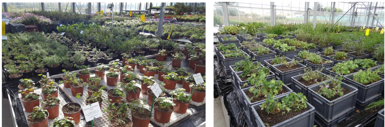
Figure 1 Préparation des gammes de plantes et plantation dans le sol pollué en bac lysimétriques.
